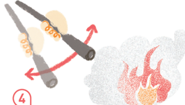
「掃」 向火源根部左右移動掃射
