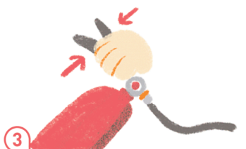
「壓」 壓下手壓板，滅火劑噴出
